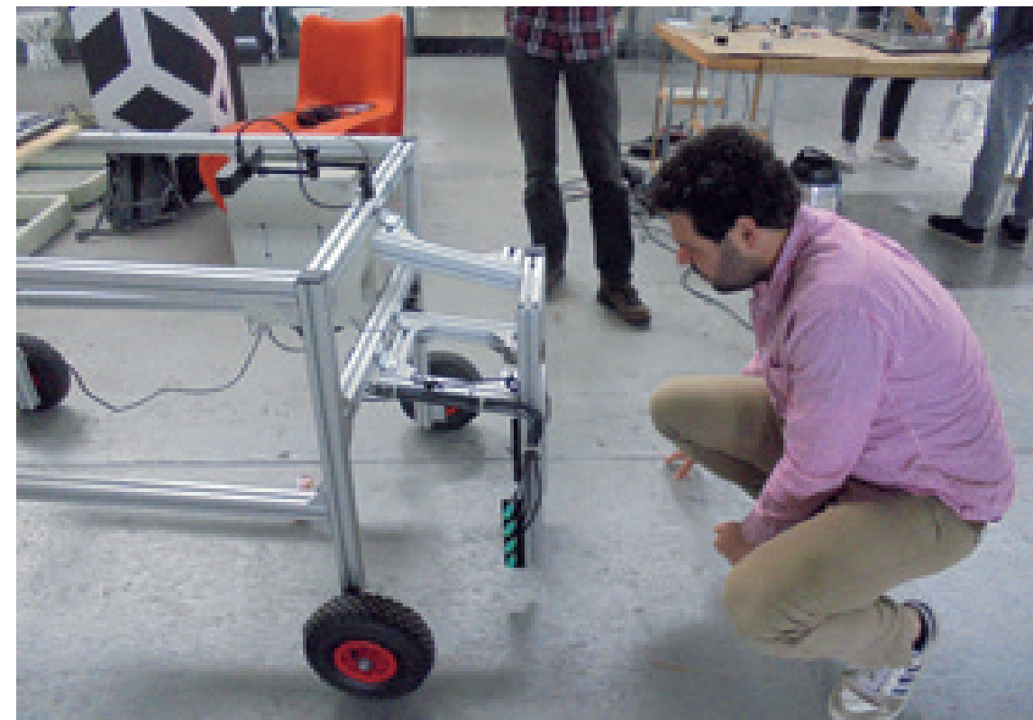
De dichtheid wordt gemeten met apparatuur op een verrijdbare kar.
